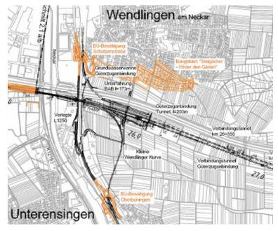
Der Plan zeigt die Einschleifung der Güterzugstrecke und die Wendlinger Kurve. Plan: DB Projektbau
